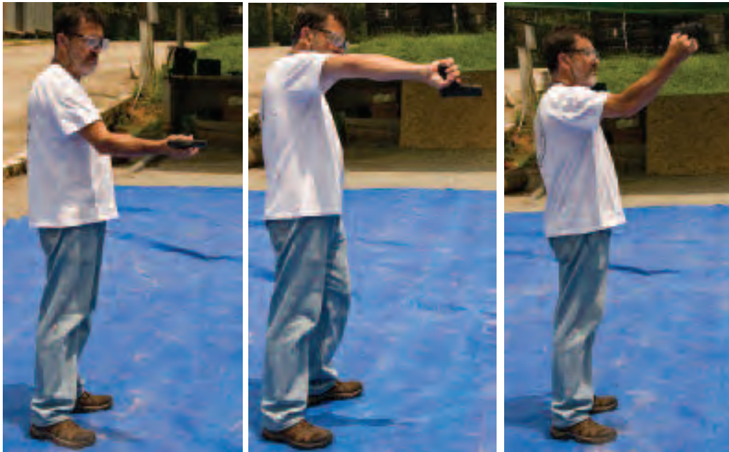
Na tentativa de fazer a arma falhar, disparamos a PT 709 “de lado”, de “cabeça para baixo” e, por fim, segurando-a apenas com dois dedos. Não conseguimos provocar falhas.
